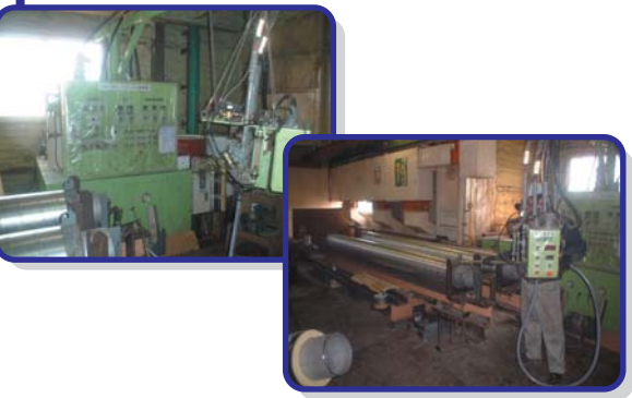
6. 硬質ウレタンフォーム注入発泡 温度管理・注入角度を計算し完璧な 保温材充填を行います。
