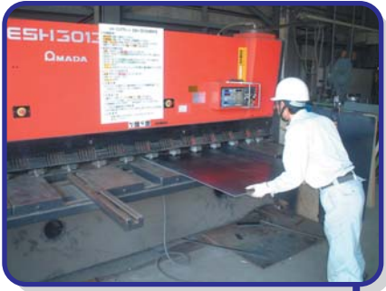
1. シャーリング 板厚 13mm、幅 3,000mm までの 切断加工が可能です。
