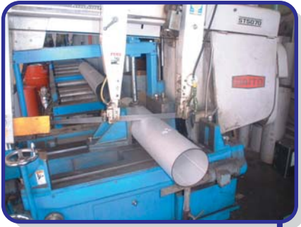
2. 切断加工 熟練職人により施されます。 最小口径～ 550A までの切断が可能です。
