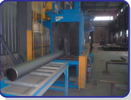
7. ショットブラスト処理 専用ヤードにて鋼管・鋼材を容易に確実に ブラスト下地処理します。
