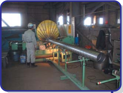
3. スパイラル成形 φ175 からφ1,000 までの加工が可能です。 (mm単位での製造が可能です)
