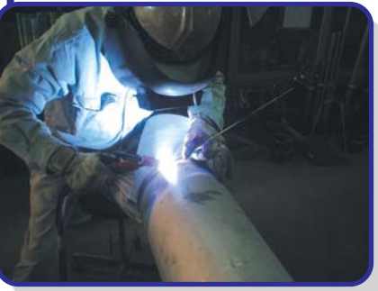
4. 鋼管溶接 専属熟練有資格溶接者によるステンレス鋼管を 主とした精度の高い溶接を実現します。
