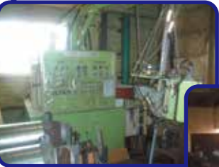
6. 硬質ウレタンフォーム注入発泡 温度管理・注入角度を計算し完璧な 保温材充填を行います。
