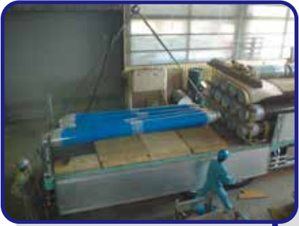
11. 完成品積み込み 完成品は1本1本丁寧に運送車に 積み込みを行います。
