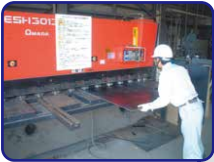
1. シャーリング 板圧 13mm、幅 3,000mm までの 切断加工が可能です。
